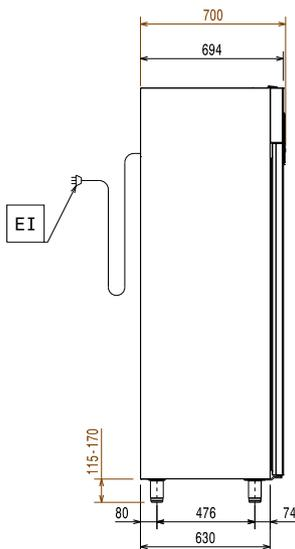
EI = Conexión eléctrica (energía)
